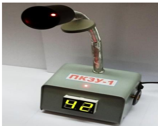
Рис. 1. Внешний вид электронного прибора ПКЗУ-1, диагностирующего функциональность зрительного анализатора и двигательную утомляемость у теннисистов
